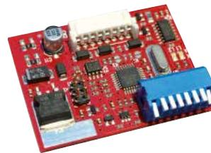
CARD FOR REMOTE CONTROL OF WIPER/WASHER PUMP WITH WASPT FOR STAND-ALONE CAMERA HOUSINGS
