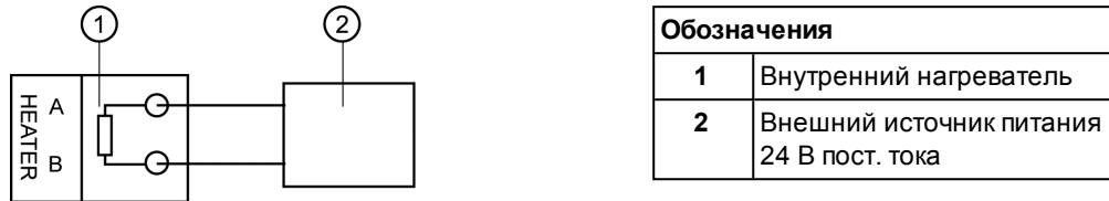
Рис. 4-13: Пример проводки для внутреннего нагревателя
