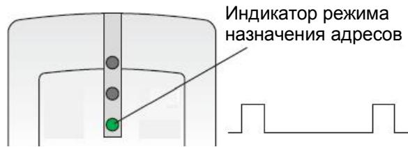
Режим назначения адресов отображается миганием зеленого индикатора на считывателе (короткие импульсы с длительной паузой).
