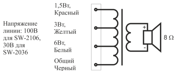
Рис. 2. Схема подключения оповещателя.
