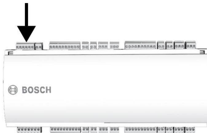
Рис. 4.9: Расположение шины модуля расширений RS-485
