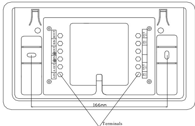
A IN, B IN: подключается к клеммам А и В соответственно, на повторителе
