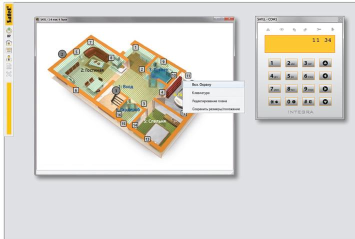
Основной функцией программы GUARDX является отображение состояния системы с помощью графических планов объектов. Эти планы могут отображать в режиме реального времени состояние отдельных разделов (групп) системы: охрану, тревоги, тампер и прочие состояния. В зависимости от полномочий диспетчера с их помощью можно управлять системой, например ставить или снимать раздел с охраны.
