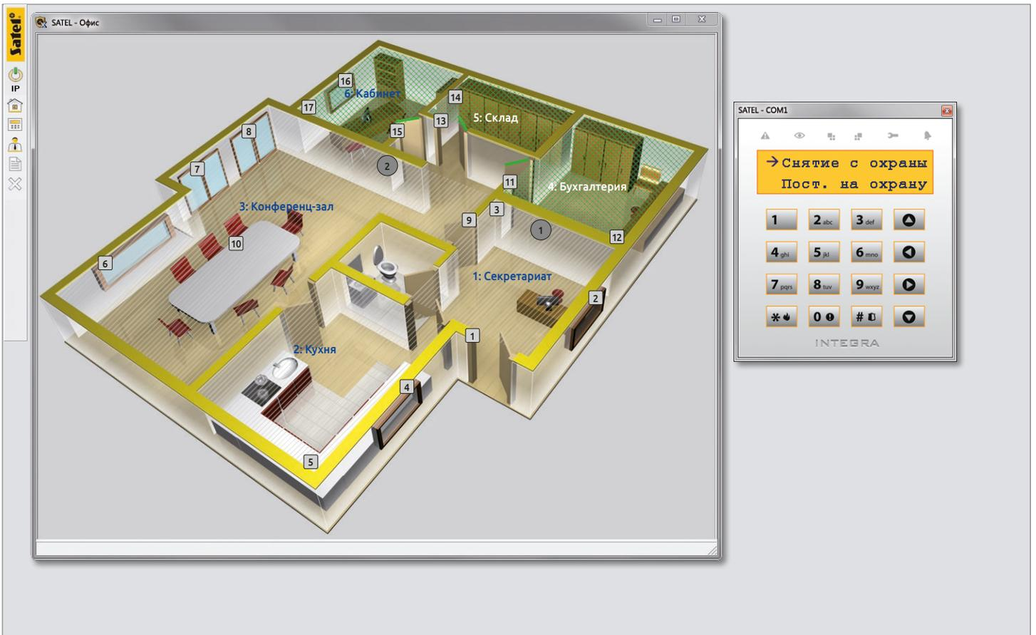
Программа GUARDX дает диспетчеру доступ практически ко всем функциям ПКП с помощью виртуальной клавиатуры, которая предоставляет идентичные возможности как стандартная клавиатура прибора.
