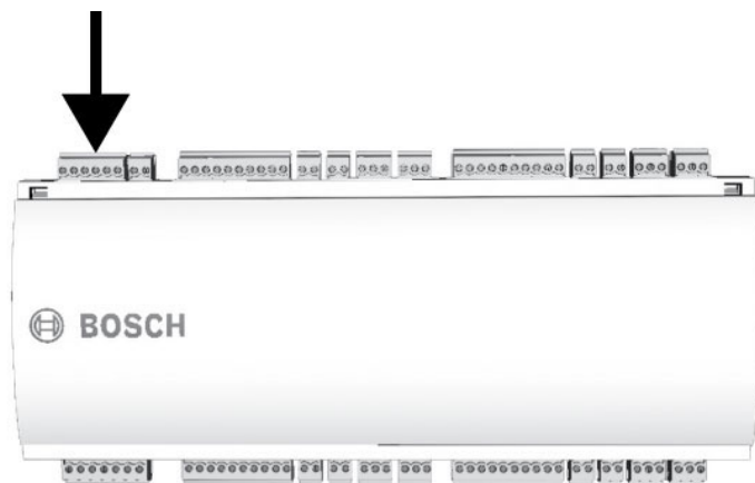
Рис. 4.50: Расположение шины модуля расширений RS-485
