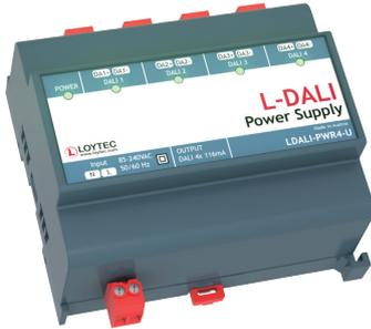
Источники питания LDALI-PWR2-U и LDALI-PWR4-U используются для питания двух или четырех DALI каналов. На каждый канал блоки питания обеспечивают до 116 мА для питания устройств, подключенных к DALI каналу. Если суммарное потребление подключенных DALI устройств больше 116 мА, то два DALI выхода можно использовать в параллель. Таким образом максимальный ток ограничивается 232 мА.
