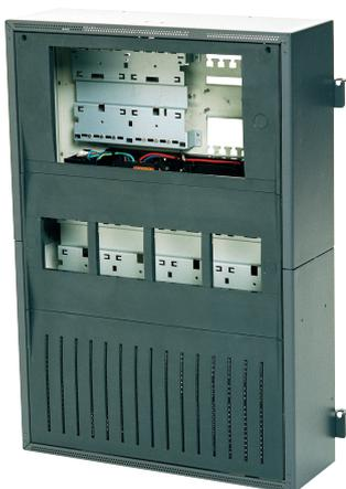
В СРН 0006 А можно разместить блок управления и индикации с контроллером панели МРС, до шести модулей, две батареи 12 В/45 Ач и источник питания. Кронштейн источника питания предустановлен. Модульная конфигурация облегчает расширение.
