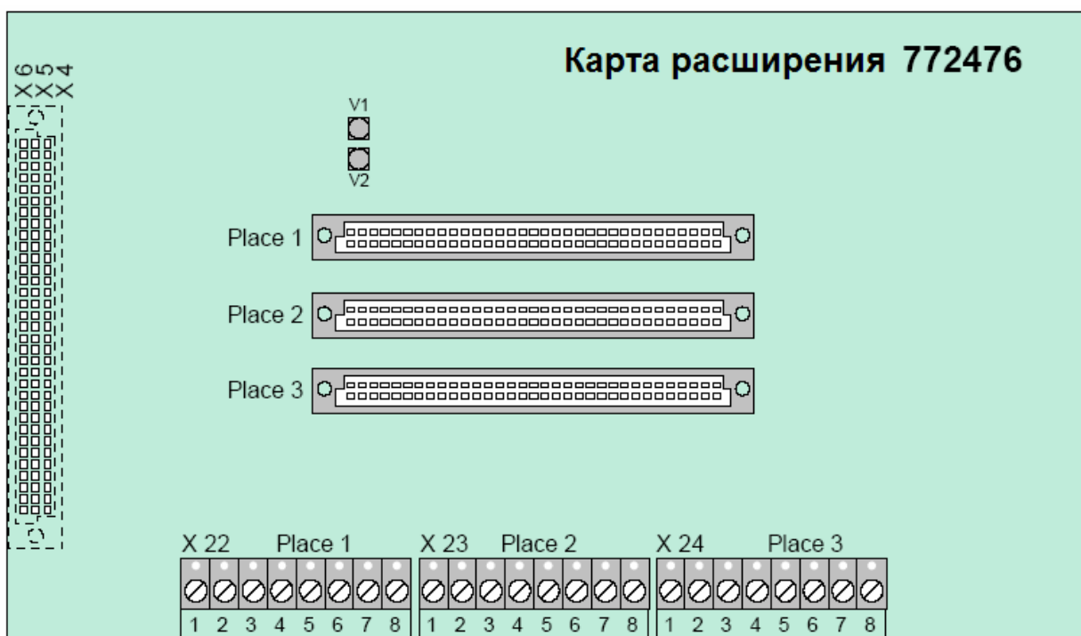
Рис. 54: Карта расширения (Но 772476) с тремя слотами для микромодулей (только для IQ8Control M)
