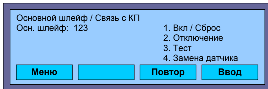
Рис. 84: Тестирование аналогового шлейфа
