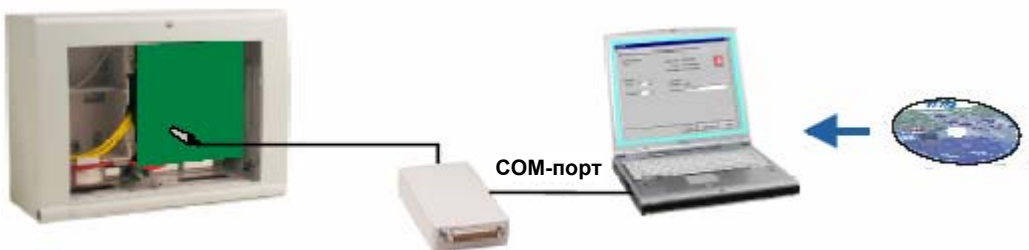
Рис. 34: Интерфейс панели (Арт.№ 769828), последовательный
