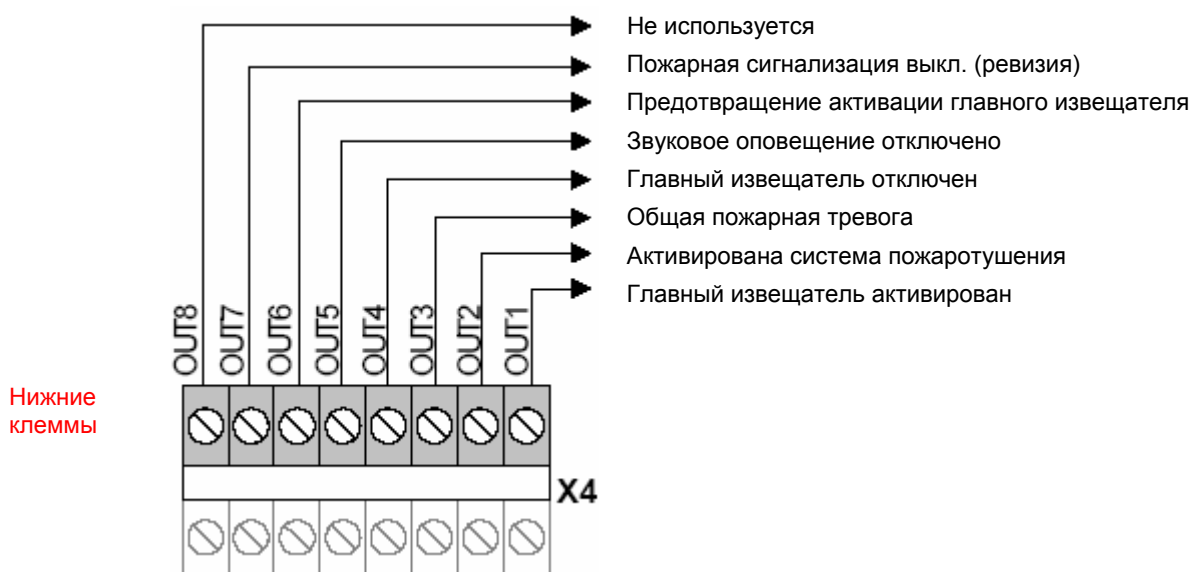
Рис. 45: Клеммы подключения унифицированного пульта пожарной бригады
