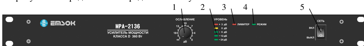
Рисунок 6.1. Передняя панель усилителя. 1 – Регулятор громкости, 2 – индикатор уровня, 3 – индикатор перегрузки, 4 – индикатор режима работы, 5 – выключатель питания.
