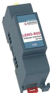
Интерфейсы L-ENO EnOcean используются для подключения беспроводных автономных датчиков и микро-мощных устройств к сети автоматики здания при помощи Серверов Автоматизации L-INX, Контроллеров Управления Помещениями L-ROC, Универсальных Шлюзов L-GATE и Контроллеров L-DALI. Для этого достаточно подключить интерфейс L-ENO к USB-порту. Устройства L-ENO питаются по USB и распознаются автоматически.
