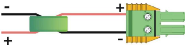
Рисунок 53: Установка ферритовых тороидов
