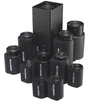
В моделях с ИК-коррекцией серий H62Z и E66Z предусмотрена функция "Антитуман". При её активации в оптическую схему вводится ИК-фильтр, отсекающий рассеянный видимый свет и пропускающий ИК-излучение с длиной волны 850нм. Это позволяет повысить контрастность изображения в условиях дымки, тумана и других атмосферных осадков и загрязнений.
