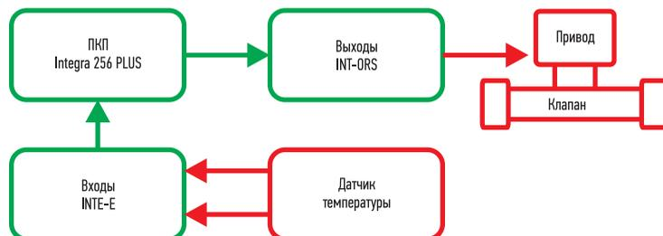
**РИС. 4.** ◀ Автоматическое регулирование отопления
