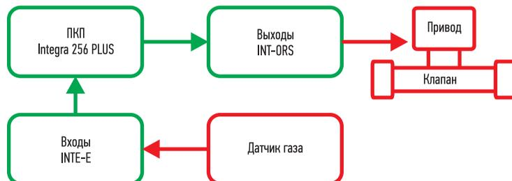
**РИС. 1.** ◀ Перекрытие клапанов газопровода при утечке газа
