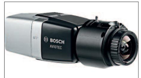
Подключив камеру к сети Ethernet, можно конфигурировать систему AVIOTEC и отслеживать ее состояние с компьютера или мобильного устройства, а для передачи сигналов тревоги камера Starlight 8000 оснащена релейным выходом. В отличие от дымовых извещателей, данная система нечувствительна к пыли и пару и может контролировать помещения большой площади – под ее защитой находится все поле зрения видеокамеры.
