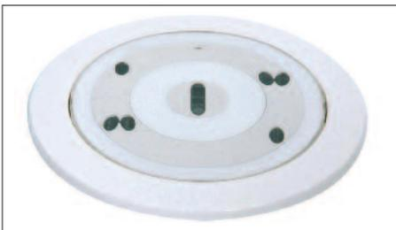
"Невидимость" извещателей Bosch обеспечивается за счет отсутствия у них обычной дымовой камеры, для детекции дыма устройства используют воздушное пространство перед собой. Встроенные в них светодиоды формируют направленные под определенным углом лучи, и при возникновении пожара часть света рассеивается на частицах дыма и попадает на чувствительные фотоэлементы извещателя.
