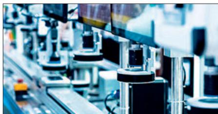
Особое место занимает в линейке Fujinon оптика серии HF-FA – компактные объективы 1,5 Мпкс с отличным соотношением цены и функциональных возможностей, лидеры продаж. Они рассчитаны на максимальный размер матрицы 2/3", имеют фиксированное фокусное расстояние в миллиметрах (6, 9, 12,5, 16, 25 и т.д.) и с запасом соответствуют профессиональным стандартам. Эти объективы демонстрируют образцовую ЧКХ и четкость линий.
